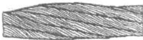
Рис. 13. Местное увеличение диаметра каната
