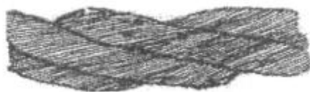
Рис. 1. Обрывы и смещения проволок каната крестовой свивки
